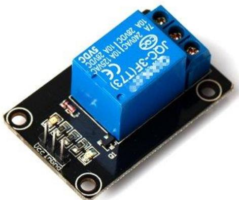
Figura 26 : PCB ospitante il relè dedito all’azionamento del perno usato per l’aggancio/sgancio della bicicletta alla rastrelliera
